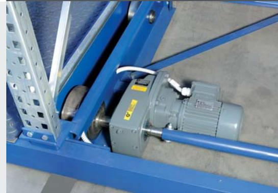
Detailansicht des leistungsstarken und wartungsfreien Getriebemotors
