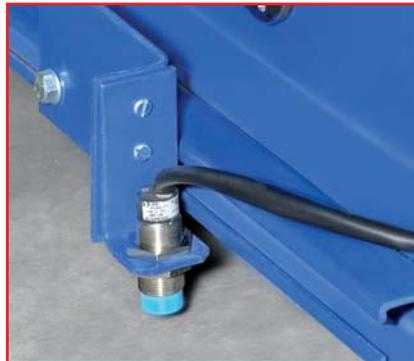
Endabschalter (Induktivschalter) an den beiden äußeren Wagen
