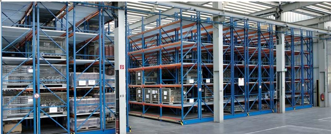
Ob Palettenregal oder Kragarmregal, beide können einfach mit dem Fahrsockel verschraubt werden und bilden so eine feste und sicher verfahrbare Einheit (Feldlasten bis 22.500 kg und Fachlasten bis 5.500 kg).
