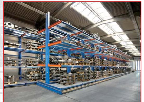
Durch die Verbindung der Kragarme mit Gitterrosten entstehen durchgehende Lagerebenen
