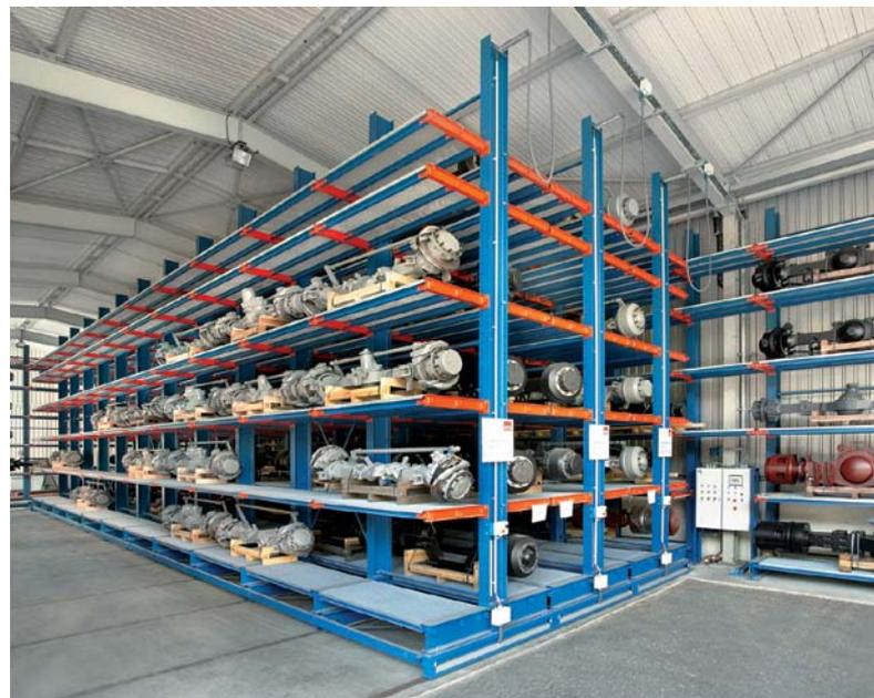
*Kragarmregale mit Gitterrostabdeckung – so entsteht eine durchgehende Ablagefläche. Ideal für Lagergut mit unterschiedlichen Abmessungen.*
