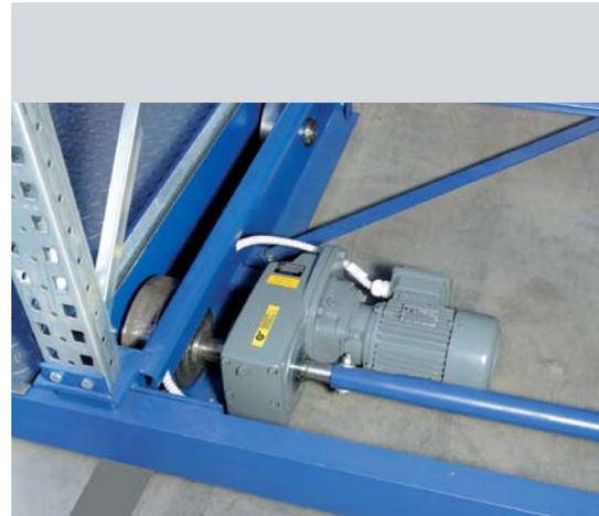
*Detailansicht des leistungsstarken und wartungsfreien Getriebemotors*
