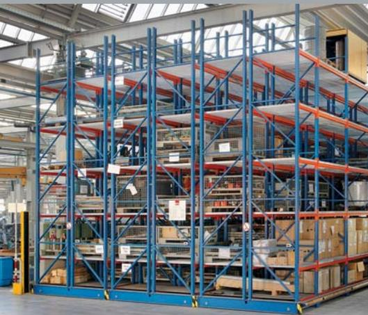
Die Paletten können längs- oder quer eingelagert werden. Die Längseinlagerung ist die effektivere Möglichkeit.
