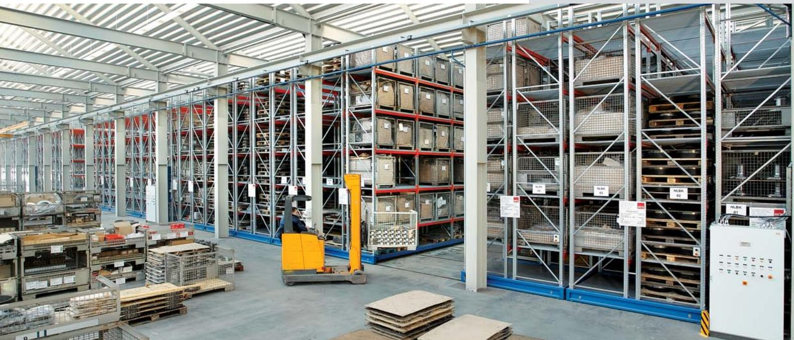
*Lager für Achsen und Gitterboxen, Bediengang geöffnet, restliche Gänge geschlossen*
