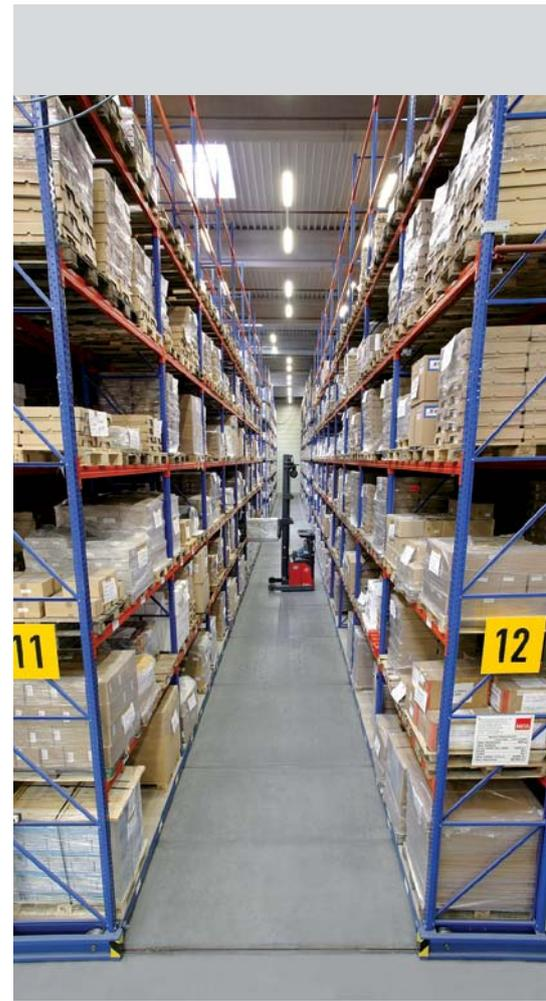
*Bedienung mit Schubmaststapler bis 10 m Höhe*
