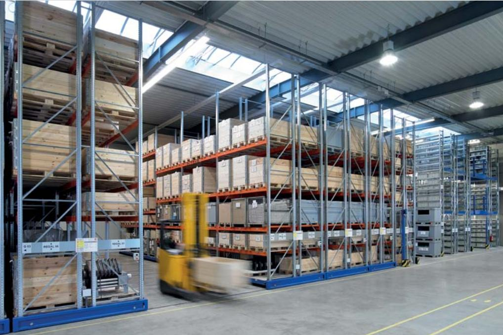
*Warenbewegung mit Frontstapler im geöffneten Gang, rechts im Bild eine dreigeschossige META-Fachbodenregalanlage für die Lagerung von Kleinteilen*
