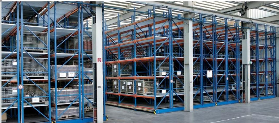
Ob Palettenregal oder Kragarmregal, beide können einfach mit dem Fahrsockel verschraubt werden und bilden so eine feste und sicher verfahrbare Einheit (Feldlasten bis 24.000 kg und Fachlasten bis 5.500 kg).
