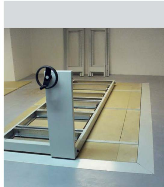
Schienenanlage mit Umlaufkante
