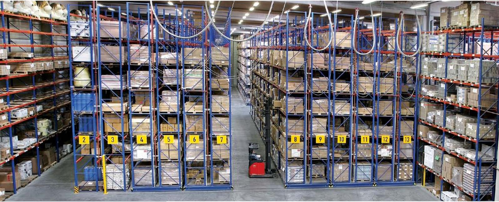
**META MULTIBLOC® Verschieberegale** machen aus Gängen und Fahrgassen nutzbare Lagerfläche. Hand- oder automatisch gesteuert werden Gänge nur dort geöffnet, wo sie auch gebraucht werden.
