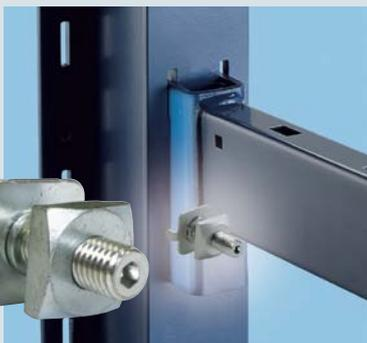
Durch Anziehen der Stellschraube wird eine gleichmäßige Vorneigung erreicht. Rundmaterial rollt so automatisch Richtung Ständer. Gleichzeitig wird eine feste Verbindung zwischen Kragarm und Ständerprofil hergestellt.
