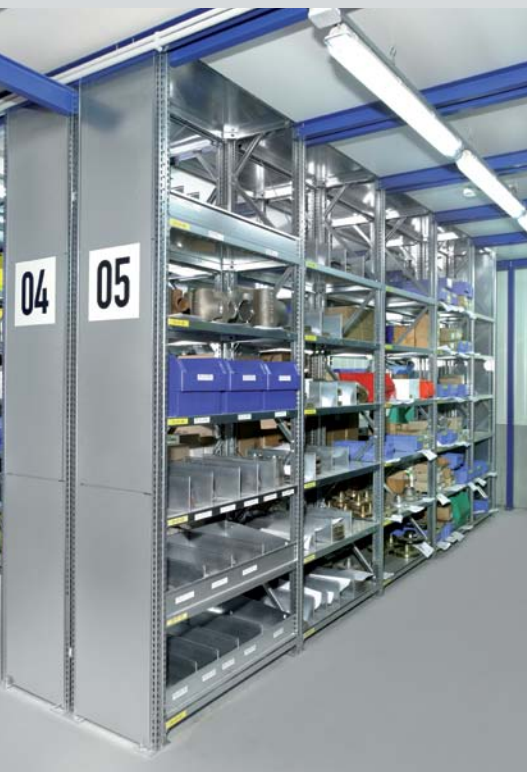
Schüttgutmulden mit Fachteilern sowie freistehende Fachteiler
