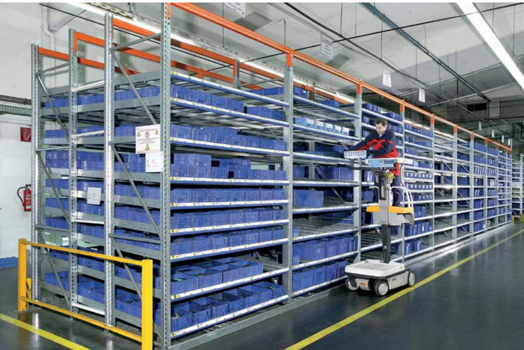
Das META MINI-RACK® Bereitstellregal hier auf der Entnahmeseite; die Ware wird mittels Bediengerät Wave entnommen
