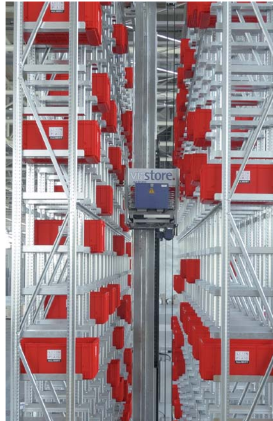
Das META HIGH-CLIP® gibt es auf Anfrage auch als Automatisches Kleinteilelager (AKL)
