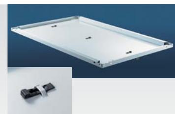
Die Befestigung der **Mittelanschläge** im 600 mm tiefen Fachboden erfolgt mit drei Kunststoffkeilen, die an der Bodenunterseite eingeschoben werden und somit den Mittelanschlag arretieren
