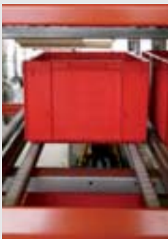
Individuelle Einstellbarkeit der Röllchen- und Trennleisten
