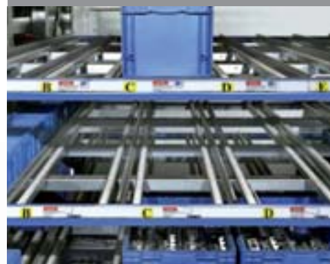
Auf stabilen Röllchenleisten gleiten die Kästen zur Entnahmeseite.
